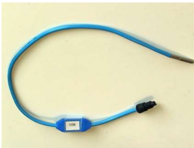
Sensore Intelligente di temperatura ed umidità connesso al Radio Node.
