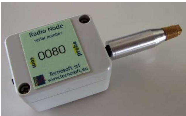
Sensore Intelligente di temperatura ed umidità connesso al Radio Node.
