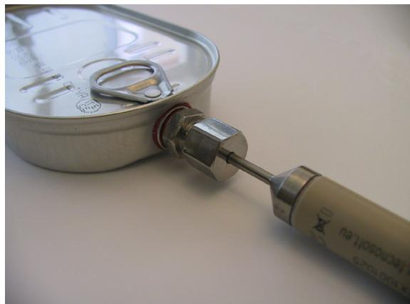
**SterilCyl** fissato su una confezione di latta (pesce in scatola) usando la dado di bloccaggio e l'inserto filettato su una superficie molto curva
