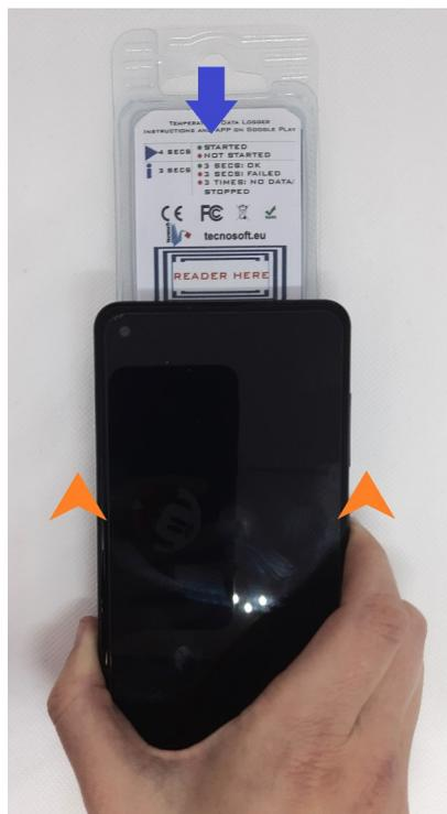
Posizionare il data logger con il retro rivolto verso l'alto, il sensore è posizionato sotto la scritta "READER HERE", far scorrere il retro del telefono verso l'alto fino ad avvertire una vibrazione, a quel punto fermarsi ed attendere l'evoluzione della schermata.
